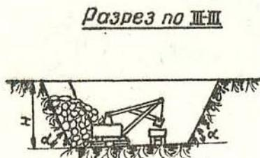
Рис.34. Послойная проходка траншей с комбинированным транспортом при рыхлении узкой полосой
